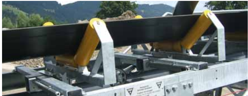
Bandwaage eichfähig – Messung über 2 Rollenstühle
