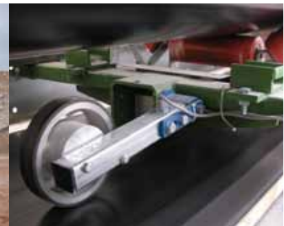
Robustes Messrad (Tacho hermetisch abgeschirmt)
